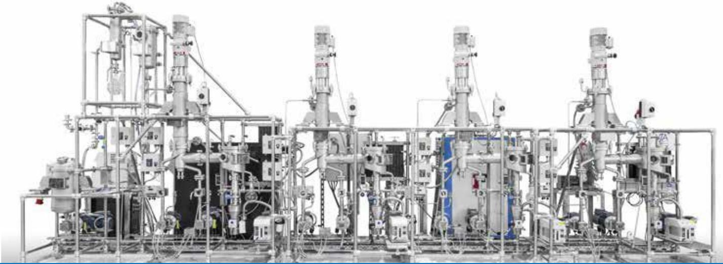
在多级蒸馏装置中，复杂的产品混合物可以分离成满足用户需求的单一组分。
